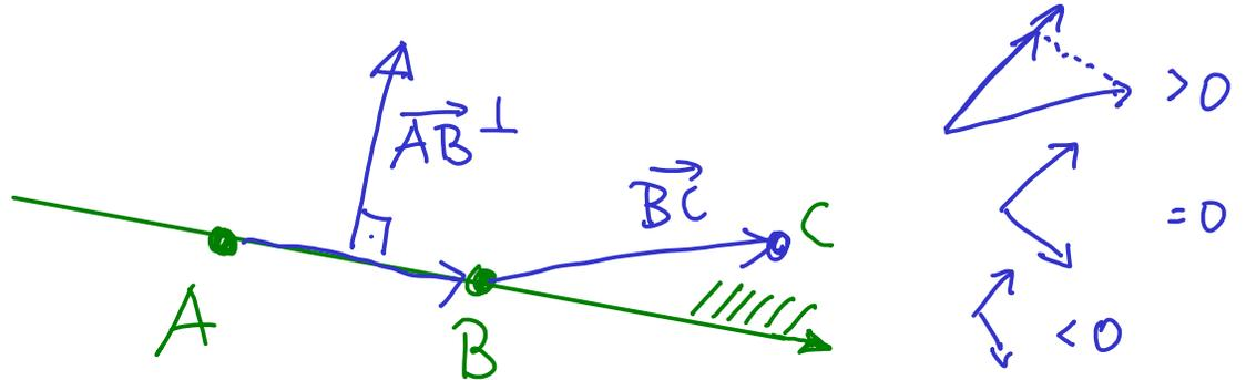
$$D = \vec{AB}^\perp \cdot \vec{BC} \begin{cases} > 0 \\ = 0 \\ < 0 \end{cases} \Leftrightarrow C \text{ liegt } \begin{cases} \text{links von} \\ \text{auf} \\ \text{rechts von} \end{cases} \text{ der gerichteten Geraden } \vec{AB}$$
