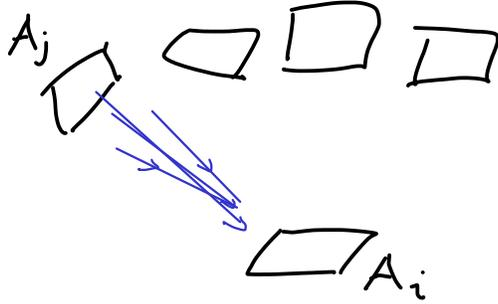
$$\underbrace{\left( \sum_{j=1}^n \underbrace{M_j \cdot |A_j| \cdot F_{ji}}_{\text{Lichtstrom aus } A_j} \right) \rho_i}_{\text{Lichtstrom in } A_j} \Big/ \underbrace{|A_i| + E_i}_{\substack{\text{spezifische Lichtausstrahlung von } A_i \\ \text{durch Eigenstrahlung (Lichtquelle)}}} = M_i$$
